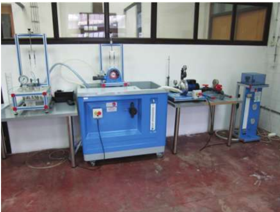
Лабораторијски стенд за анализу коришћења енергије водног шока
