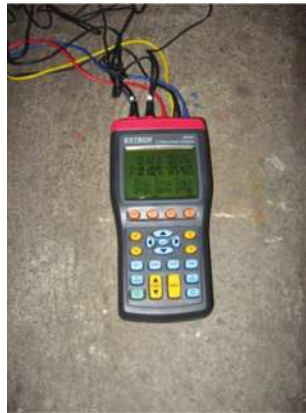
Мерење параметара електричне енергије у индустријском предузећу
