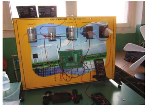
Лабораторијски стенд коришћење горивних ћелија – ветрогенератора – фотонапонских панела
